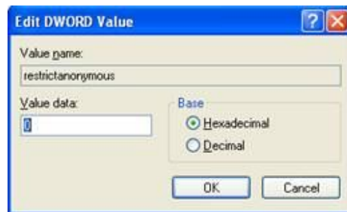
شکل ۷: اصلاح کلید Restrict Anonymous در ثبت اولیه.
