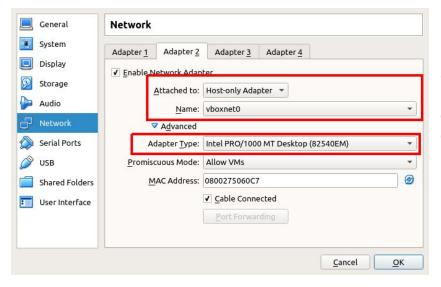
Na aba de "Network", habilite outro adaptador como "Host-Only". Configure à uma interface de rede existente e cick em "Ok"
