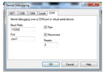
Para iniciarmos uma sessão de debugging no windbg, vá até a aba "COM" e insira as configurações setadas na máquina alvo, por e dê um "OK"
