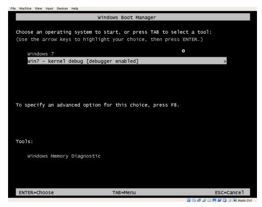
Essa opção será exibida quando a máquina alvo for reiniciada, selecione a opção "Kernel Debug [debugger enabled"
