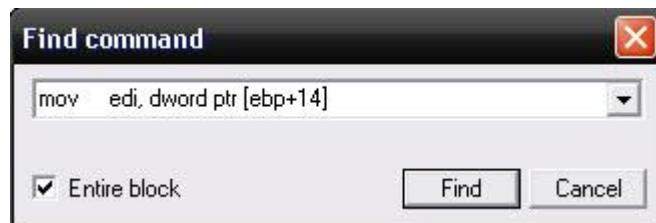
از دستورات کلیدی می توانید استفاده کنید که در جدول ذیل این دستورات آمده است (صریح و غیرصریح ، دستورات اول صریح هستند و دومی غیر صریح) . برای مثال این دستور MOV R32 , [CONST] به جای R32 میتواند هر رجیستر (ثبات) 32 بیتی باشد .
